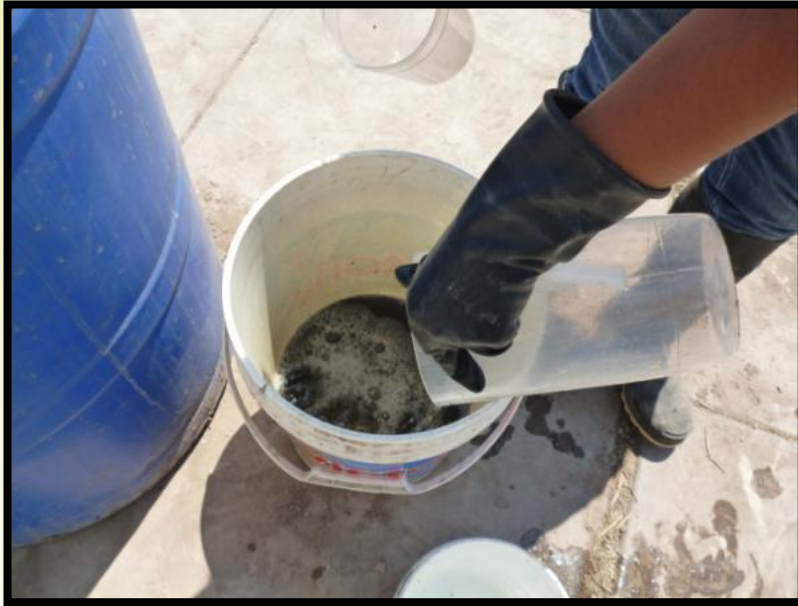
Preparación de la carga diaria para la alimentación del reactor
