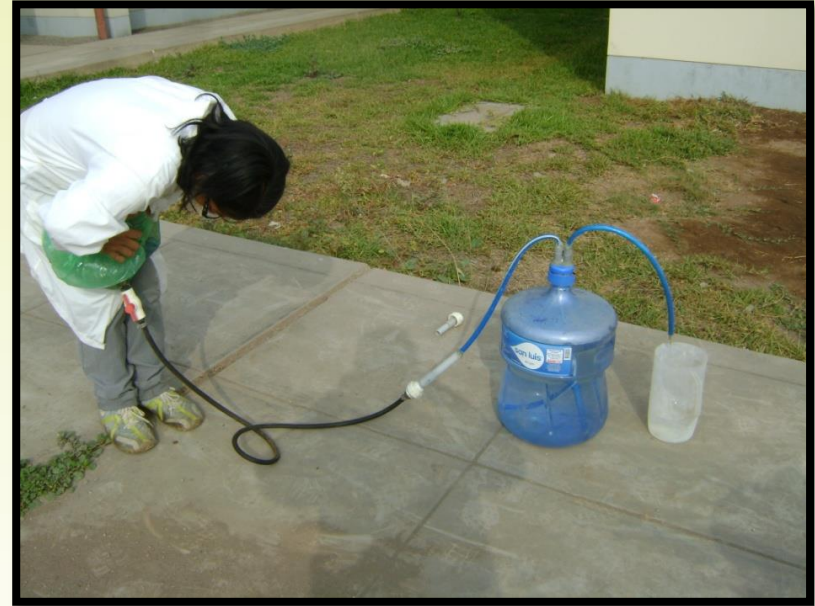
Medición de volumen de biogás
