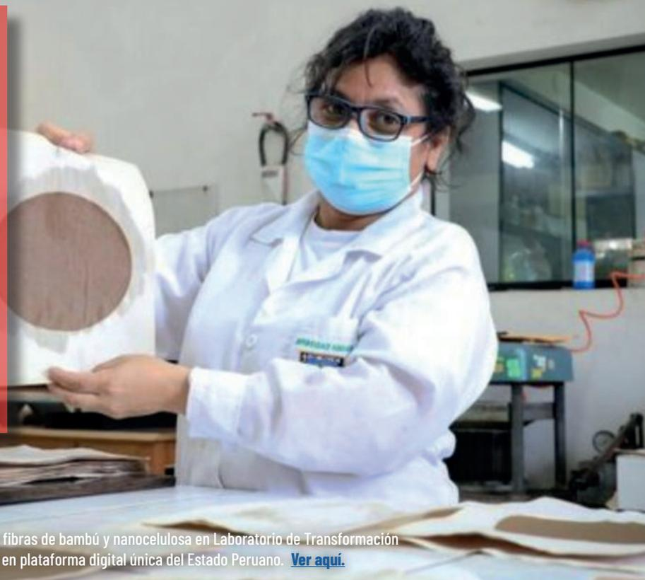
Formación de hojas de papel para alimentos de fibras de bambú y nanocelulosa en Laboratorio de Transformación Química de la Madera. Créditos: Nota de prensa en plataforma digital única del Estado Peruano. [Ver aquí.](#)
