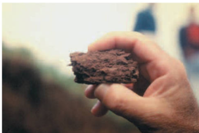
Ensayos para determinar la consistencia, friabilidad y dureza de los agregados, según el estado de humedad de la muestra.
