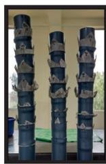
Figura 2. Sistema de mallas de acero inoxidable para el filtrado de muestras
