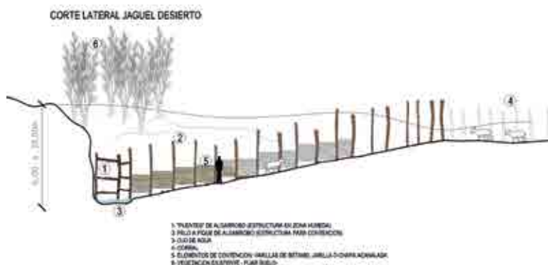
Figura 7. Esquema de corte transversal del pozo jagüel o aguada: 1- puentes de algarrobo (escalonamiento), 2- palo a pique de algarrobo, 3- ojo de agua, 4- corral, 5- elementos horizontales de contención, 6- vegetación existente (para fijar suelo).
