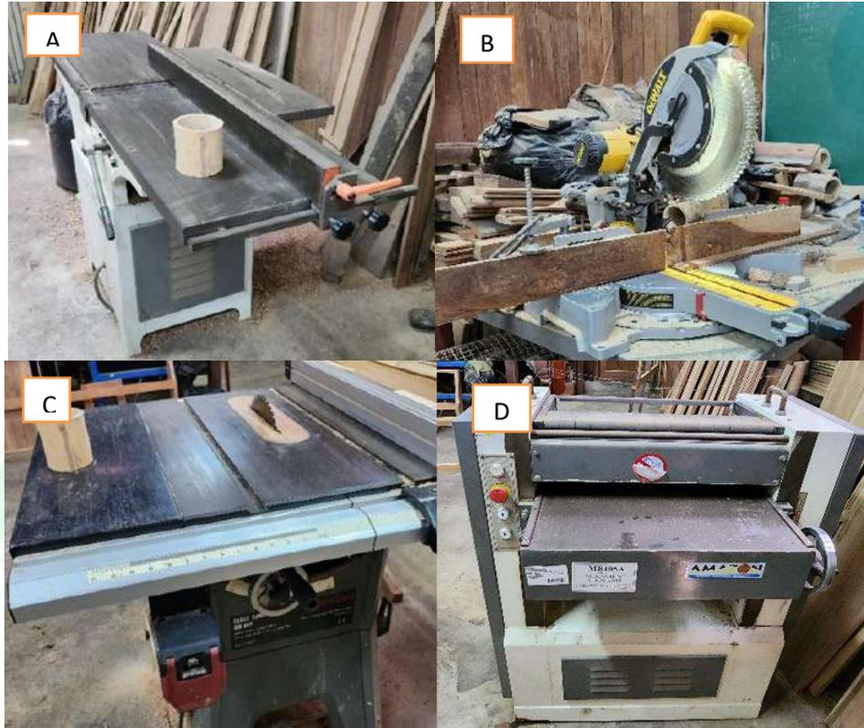
Figura 10. A). Garlopa B). Ingleteadora C). Sierra circular D). Cepilladora
