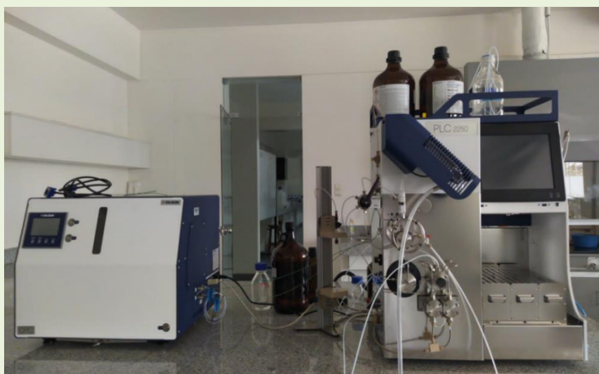
Figura N.º 4. Cromatógrafo preparativo Flash, HPLC y Partición Centrífuga (CPC) con detector de arreglo de diodos (DAD) y detector de dispersión de luz (ELSD), Marca Gilson.
