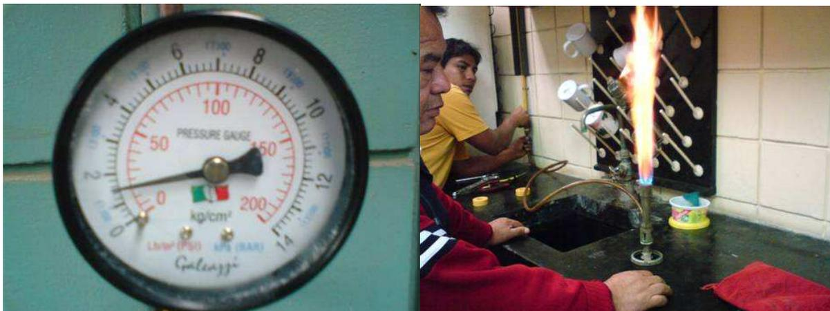
Foto N° 15.15: Pruebas de Medición y Control de los Puntos de Gas en los Laboratorios de Física
