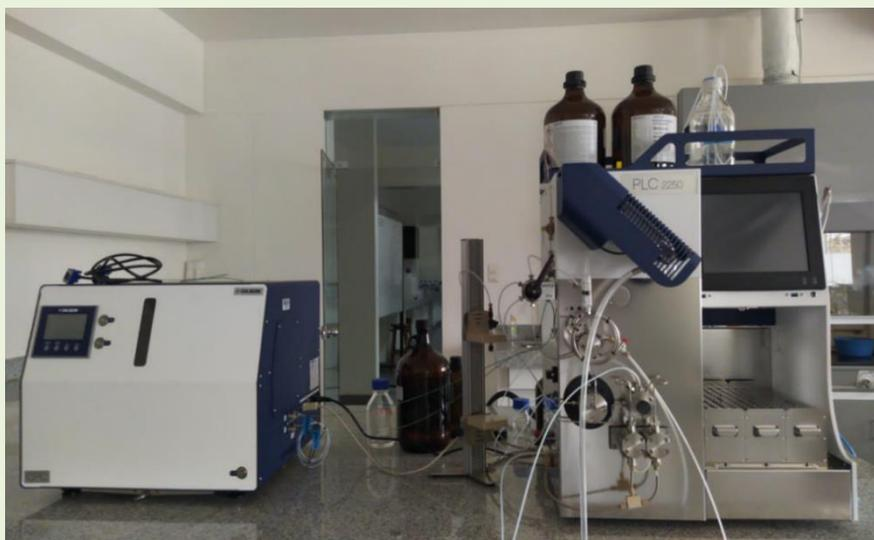
Figura N.º 4. Cromatógrafo preparativo Flash, HPLC y Partición Centrífuga (CPC) con detector de arreglo de diodos (DAD) y detector de dispersión de luz (ELSD), Marca Gilson.
